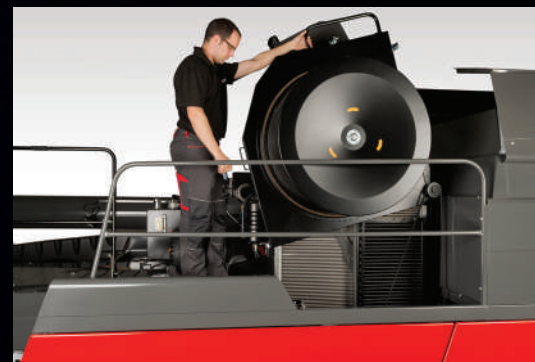
Bezpečný a snadný přístup pro čištění chladiče
