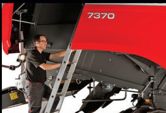
Bezpečný přístup k motorovému prostoru a zásobníku na zrno s odnímatelným žebříkem
